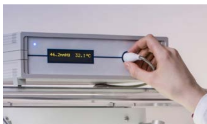
オプションの酸素モニターで、媒体や培養細胞の酸素分圧が測定できます
